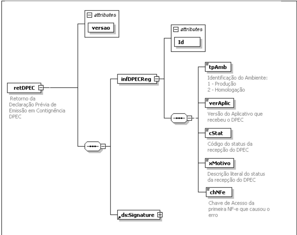
**Diagrama simplificado do retorno da DPEC processada com sucesso**
